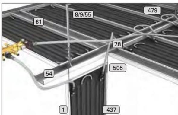
*Bild 4: Konstruktionsaufbau eines Bandrastersystems*
