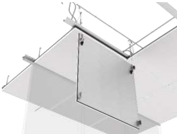
Bild 5: Abgeklapptes Deckenelement mit Aufhängung
