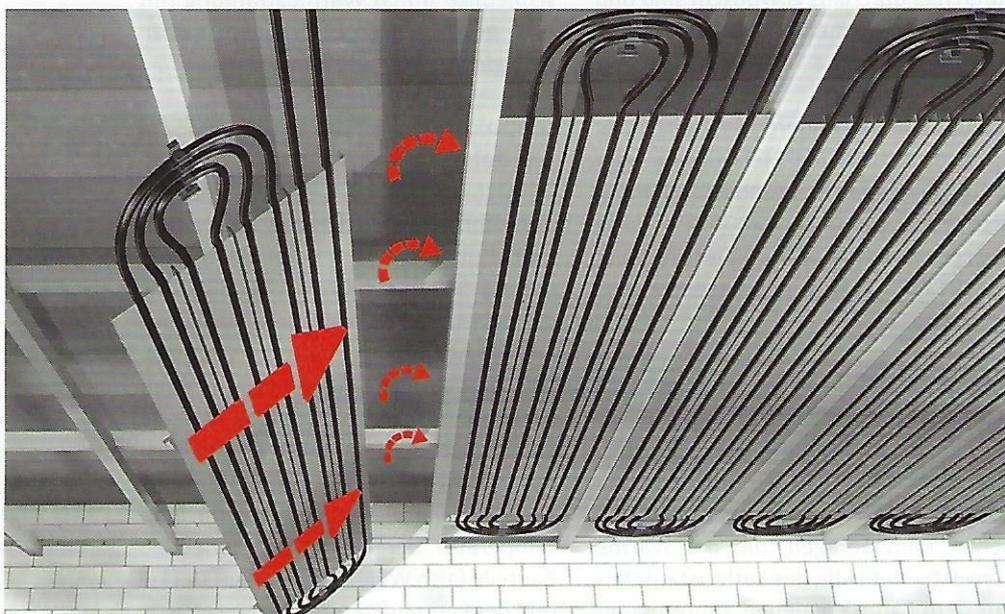
2 Die Verlegung von Deckenregistern zur Kühlung oder Beheizung erfordert eine Unterkonstruktion, in die die Elemente eingebaut sind.
