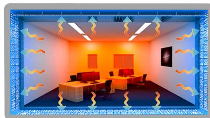
**Strahlungswärme bedeutet, dass nicht die Luft, sondern die Menschen, Gegenstände und Flächen im Raum erwärmt werden.**
