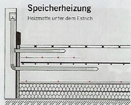
**Bild 4:** Die Speicherheizung kann auch unter dem Estrich verlegt werden
