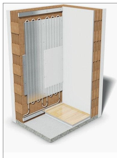
Verlegung der Rohre in oder auf einer Systemplatte mit Wandputz
