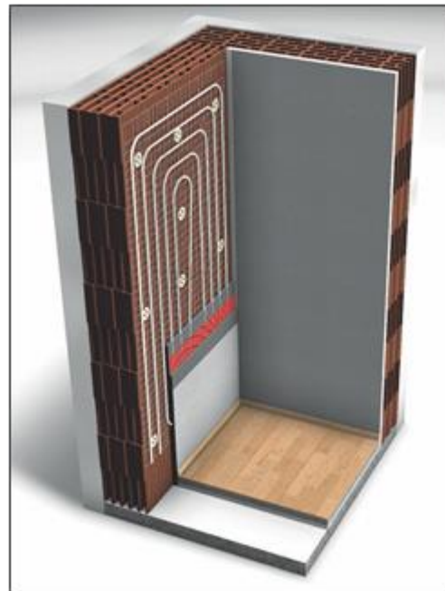
Bild 8: Beispielhafter Aufbau eines nassverlegten Wandheizungssystems
